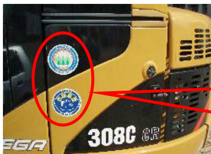
使用重機 (低騒音型重機)
