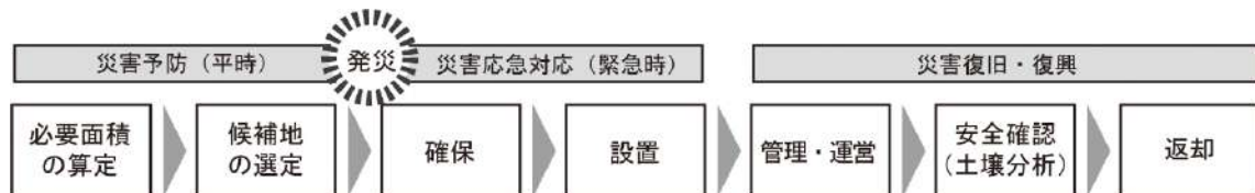
図3-3 仮置場の検討フロー（例）
