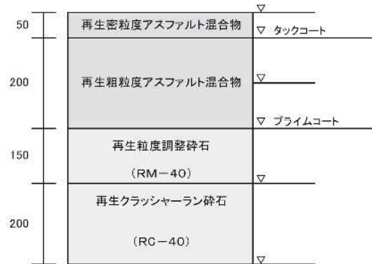
アスファルトコンクリート舗装 60型
