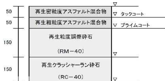
アスファルトコンクリート舗装 40型
