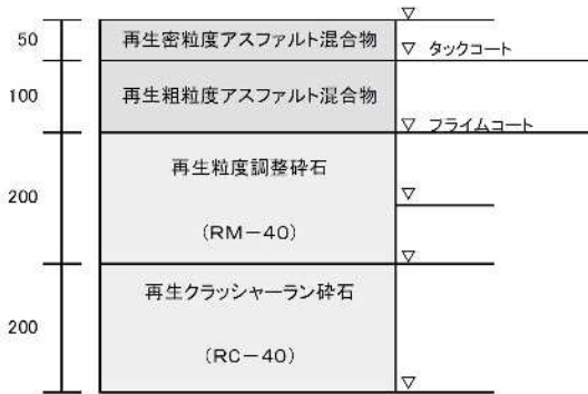
アスファルトコンクリート舗装 55型
