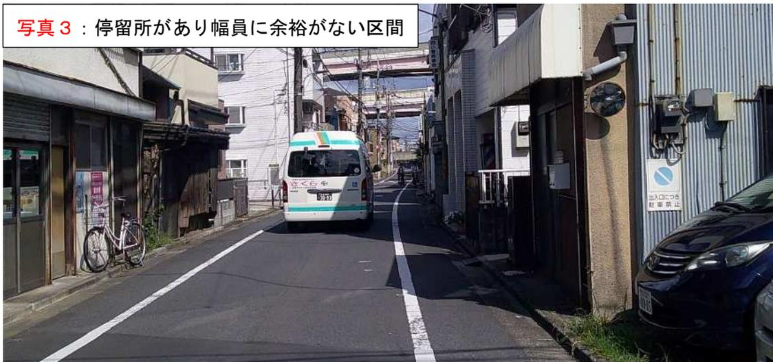
運行経路上には、写真3の一方通行道路（道路幅員 5.45m、一方通行）が存在し、バス車両での車いす乗降（側方乗降）は困難である。
